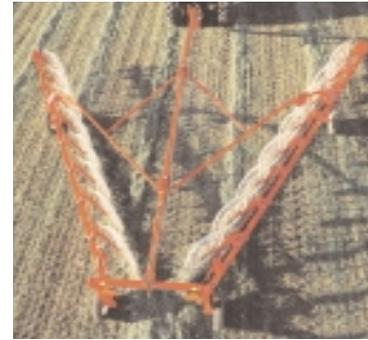
Las vigas soporte de las ruedas de barrido articulan de manera independiente sobre el bastidor principal, asegurando un excelente copiado del terreno independientemente en cualquier tipo de relieve.
