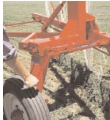
Mediante un registro de rosca se varía en forma continua el ancho de trabajo -hasta 4,60 metros- y se posiciona en transporte. En esta última posición, se ubica en línea detrás del tractor.
