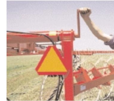
Dos registros de roscas sobre el bastidor principal, permiten variar en forma continua el ancho de la andana de acuerdo al volumen y estado del forraje.
