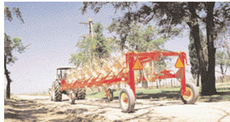
En transporte las ruedas de barrido presentan un importante despeje del suelo máximo 600 mm- que le permite cruzar zanjas, pasos a nivel, etc., sin inconvenientes.
