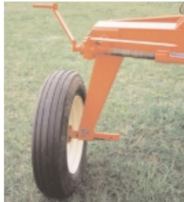
Los ejes de ruedas ofrecen dos posiciones para adaptarse al ancho de la segadora cortadora así como al de la hilera por ella proporcionada, sin riesgo de pisar el forraje.
