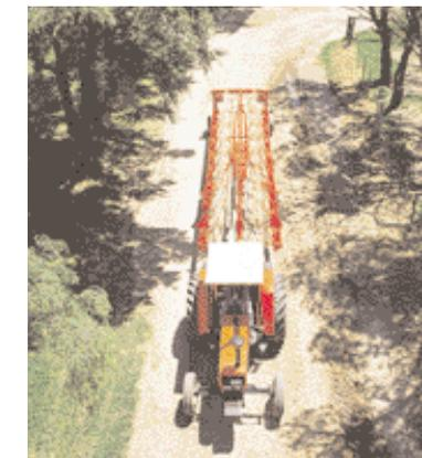
Para transporte se pliega hidráulicamente detrás del tractor y en línea con este, se bloquean los cilindros de las ruedas de barrido y se coloca una traba mecánica sobre las vigas.
